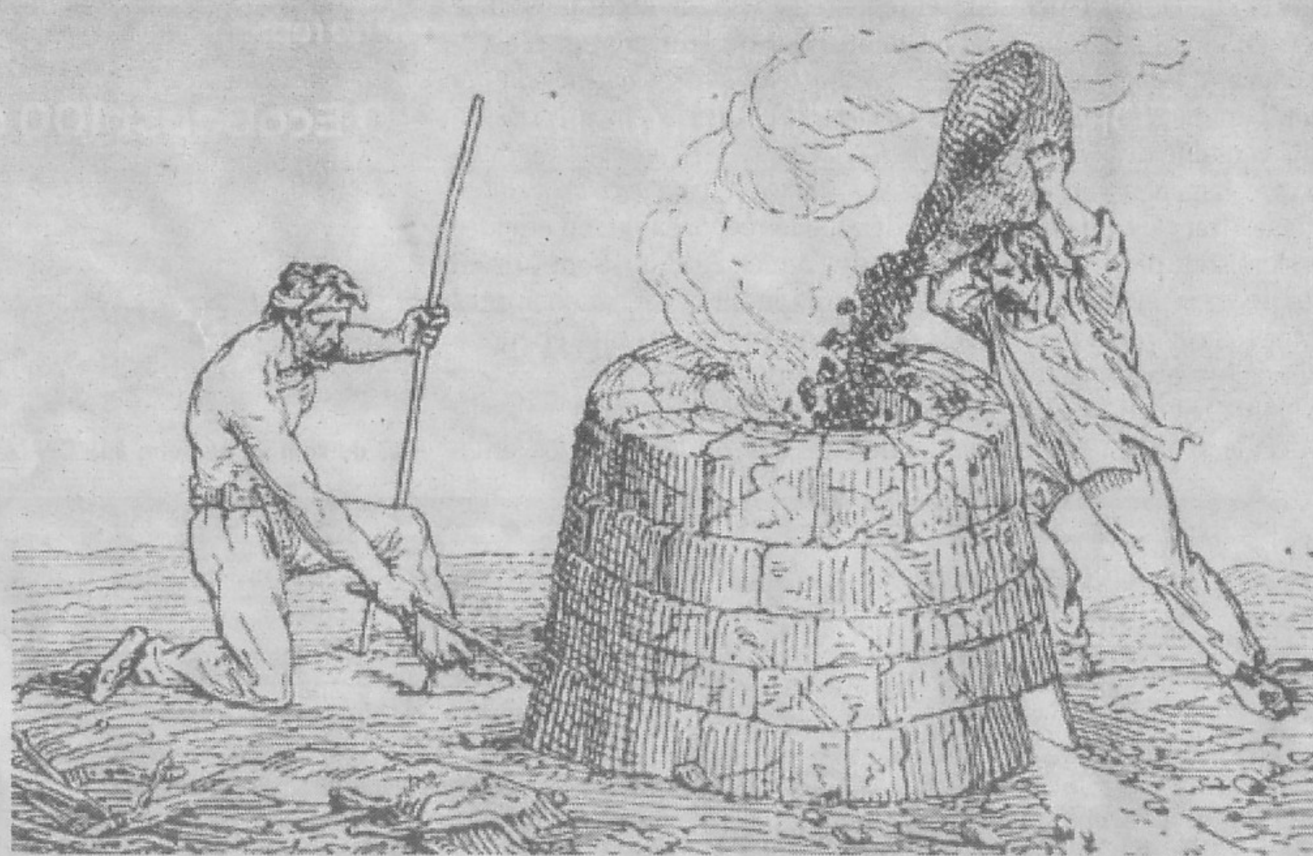
Le fonctionnement d'un bas fourneau était assez simple, mais ceux construits par les Burgondes sur le Salève étaient sans doute plus sommaires et plus petits.
