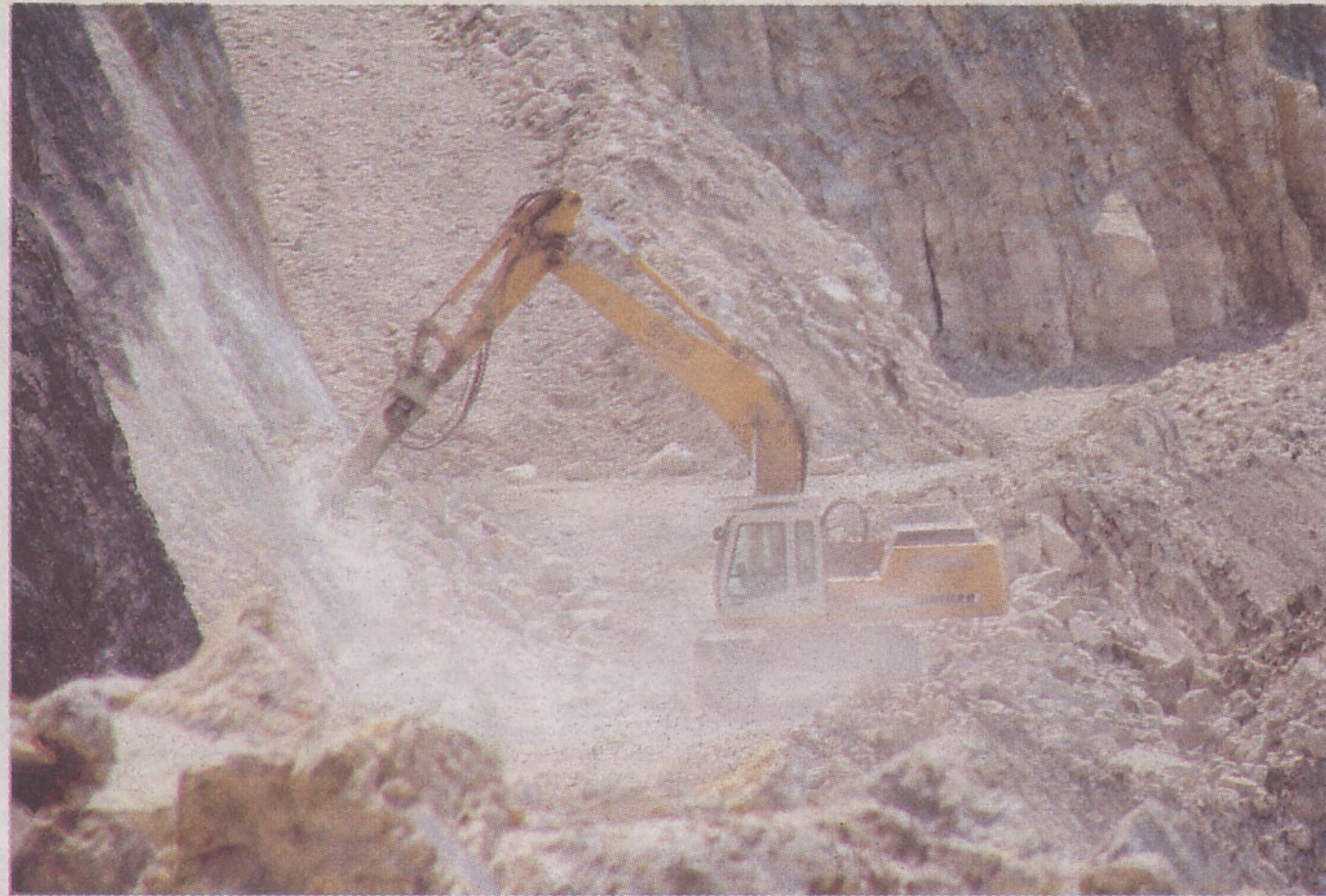
Plus d'explosions monstrueuses pour extraire les roches du Salève mais des mines et des engins performants.
