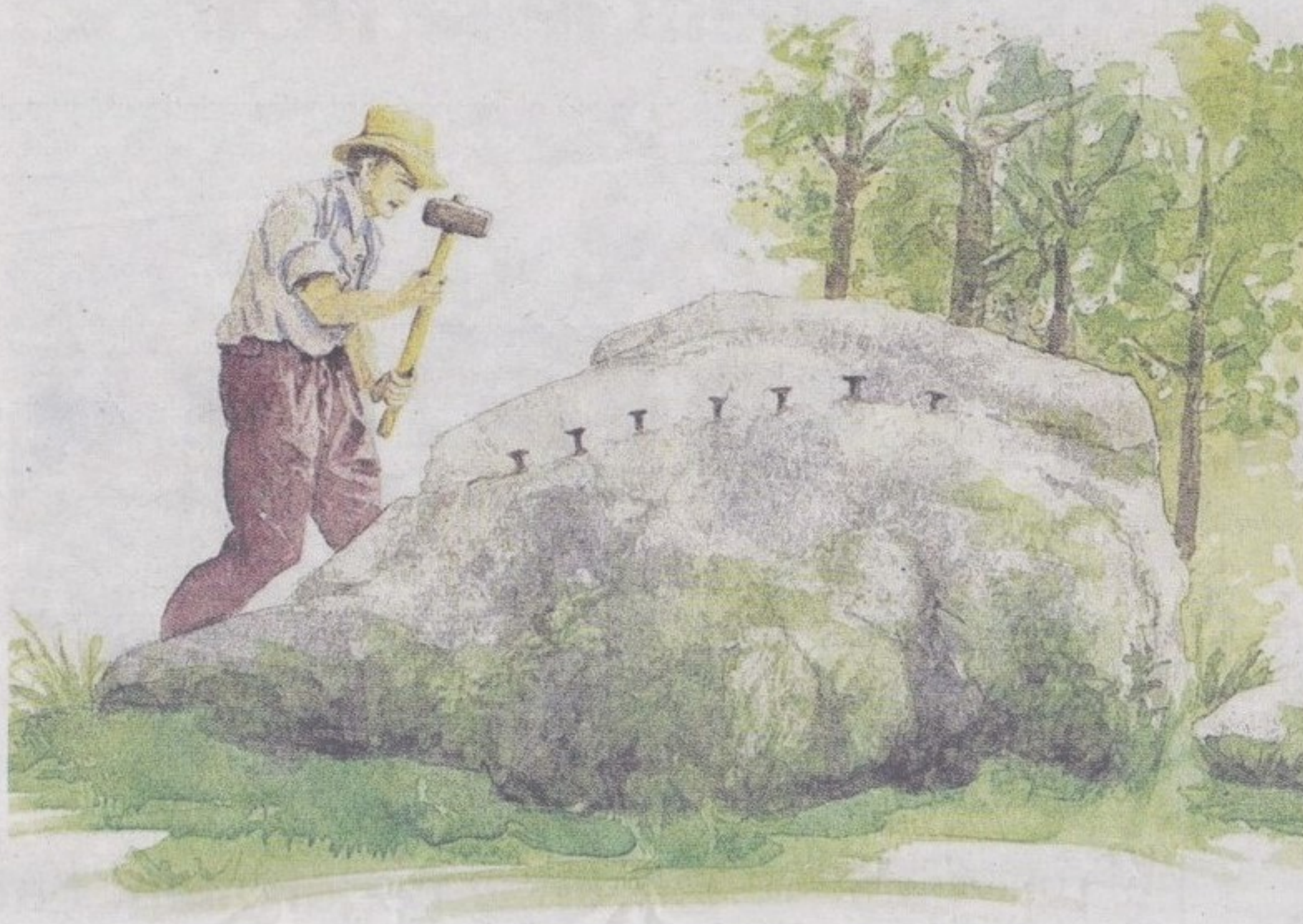
Un graniteur du mont-Sion fendant un bloc avec une masse et des coins, aquarelle de Sylvie Converset publiée dans l'ouvrage.
